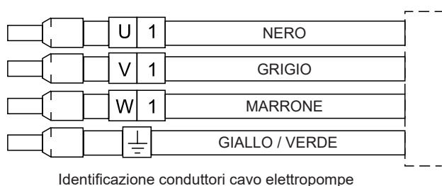
Identificazione conduttori cavo elettropompe
