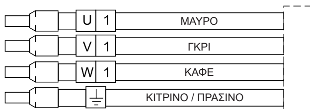
Αναγνώριση αγωγών καλωδίου ηλεκτρικών
