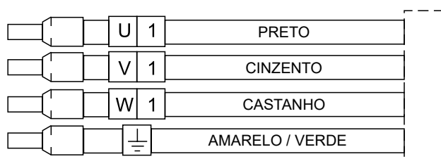
Identificação dos condutores do cabo das eletrobombas
