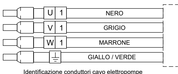
Identificazione conduttori cavo elettropompe
